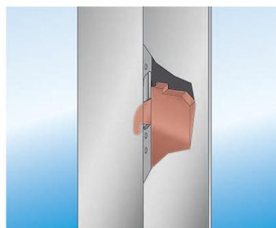
Gegenseitige Verhakung der Türflügel, im Vertikalprofil eingebaut
